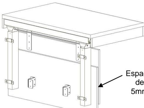
Atornille los soportes superiores bajo la encimera. Deje un espacio de 5 mm entre el panel superior e inferior. Si no es posible atornillar en el tablero a la encimera, se pueden atornillar en los brazos de soporte del sistema Flexi. Coloque los soportes superiores en los brazos de soporte y taladre orificios de  $\varnothing 3,5$  mm en los brazos de soporte. A continuación, fije los soportes superiores con los tornillos  $\varnothing 4,2 \times 10$  adjuntos.
