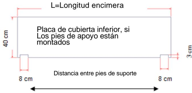
Si se montan los pies de soporte en el sistema Flexi, se debe hacer un corte en el panel inferior como se muestra en el dibujo.
