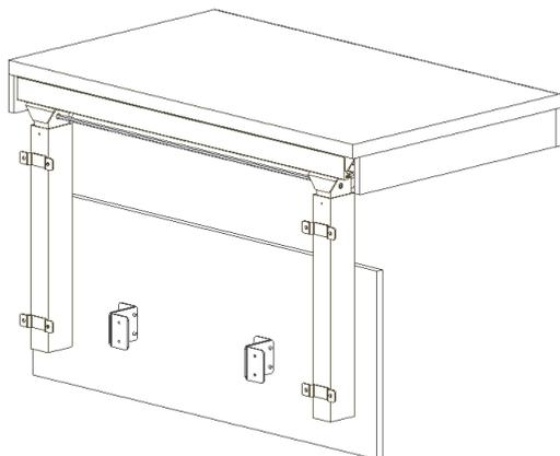
Coloque el panel inferior a los velcros. El panel debe estar apoyado en el suelo.. El tamaño del panel debe ser según el gráfico:
