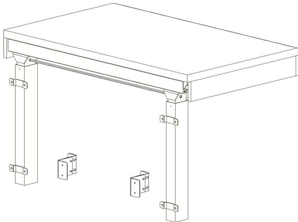
Colocar los soportes para la ocultación de las tomás de la pared. Ajustelos y asegurese de que estén rectos de acuerdo con las patas. Si el sistema Flexi tiene 3 patas, use 3 accesorios.
